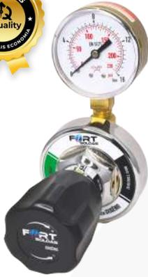
Los reguladores 947 están destinados para su uso en red (poste o línea). Pueden ser utilizados para una amplia variedad de procesos, como corte, soldadura y calefacción. Su control preciso y estable también permite su uso en demandas de baja presión. Con cuerpo de latón forjado, el regulador 947 cumple con la norma EN ISO 2503.
