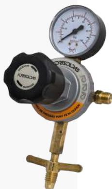
El regulador de presión FS 94 está desarrollado exclusivamente para su uso en botellas P13, pudiendo ser utilizado en GLP y gas natural. Está compuesto por una escala de fácil lectura y cuerpo forjado. Cuenta con una entrada tipo mariposa y conexión de salida para manguera 5/16".
