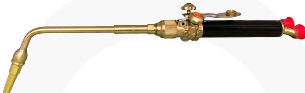
El Soplete 50-10 tiene la ventaja de mantener una pequeña llama encendida (llama piloto) cuando se presiona su palanca de acero inoxidable. Al mantener esta pequeña llama encendida en el Soplete, para reiniciar el proceso, basta con liberar la palanca y la regulación ya realizada se mantendrá, ganando así un tiempo significativo para el proceso.
